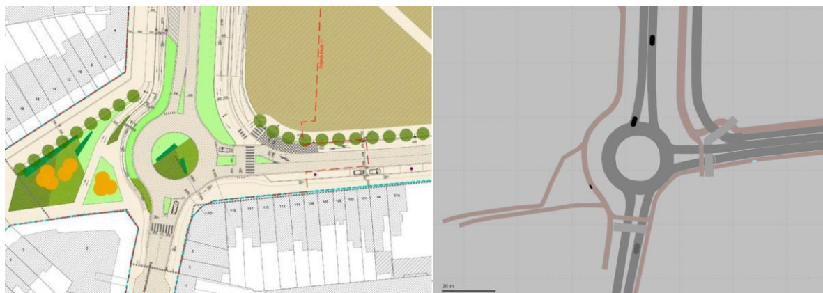
Figuur 69: Vergelijking Masterplan Stationsomgeving met microsimulatie
