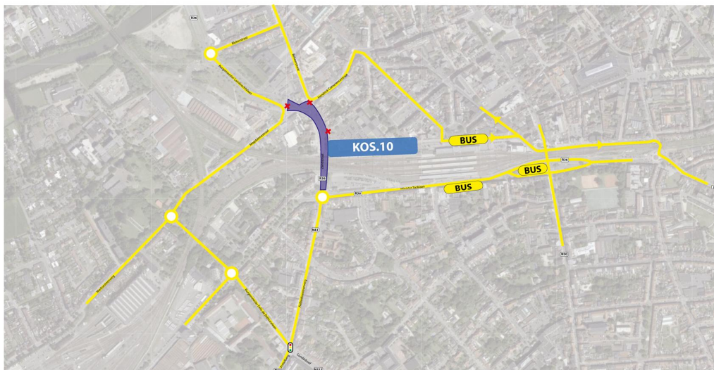
Figuur 18: Fase 014.2.1 - Omleiding busverkeer
