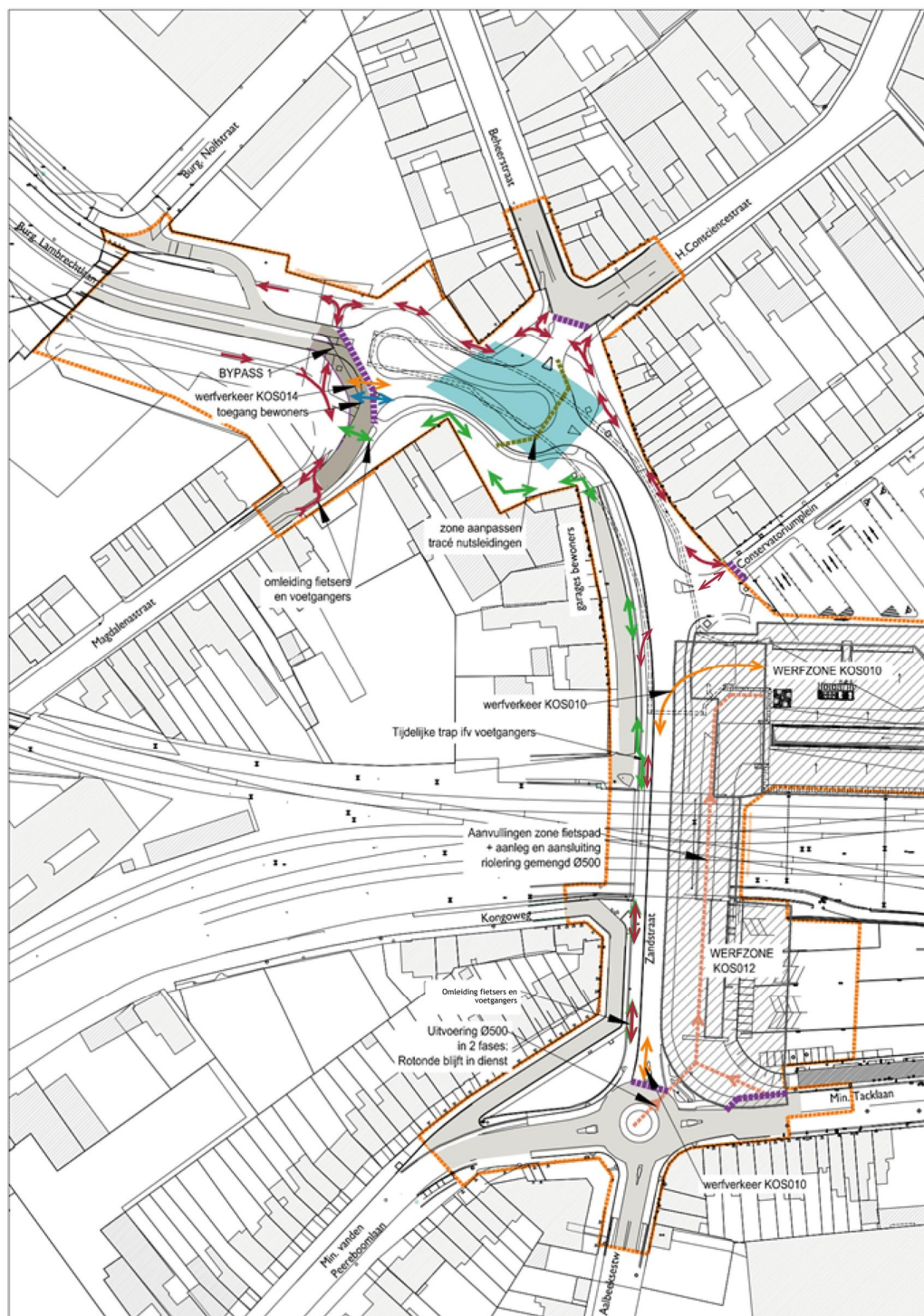
Figuur 15: Fase 014.2.1 - Aanleg rioleringen/nutsleidingen en voorbereiding bouw tunnel
