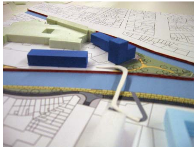
Onderbreking in de wand aan de kant van de nieuwe Leie + landing van de Reepbrug
