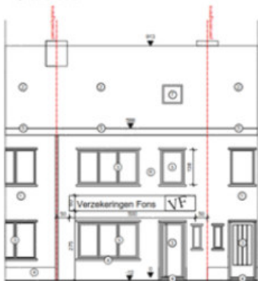
Voorgevel bestaande toestand
